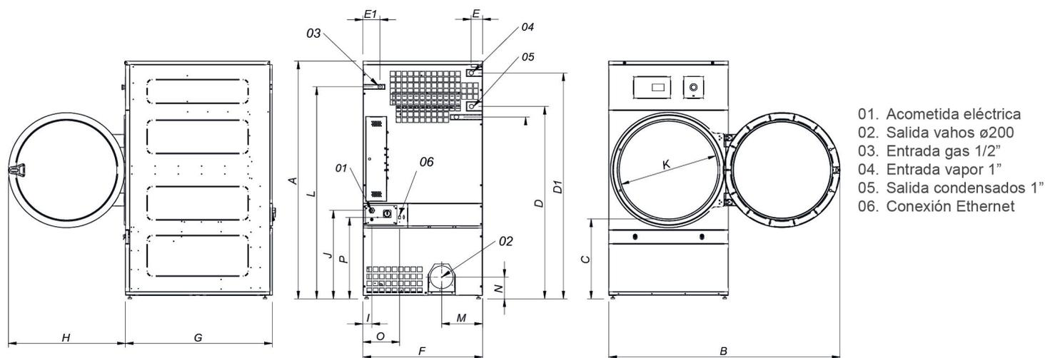
\* Medida con patas montadas (30mm)
